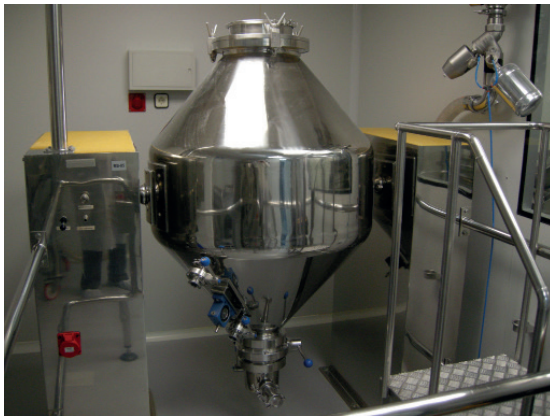
Doppelkegelmischer mit automatischem Be- und Entladesystem
