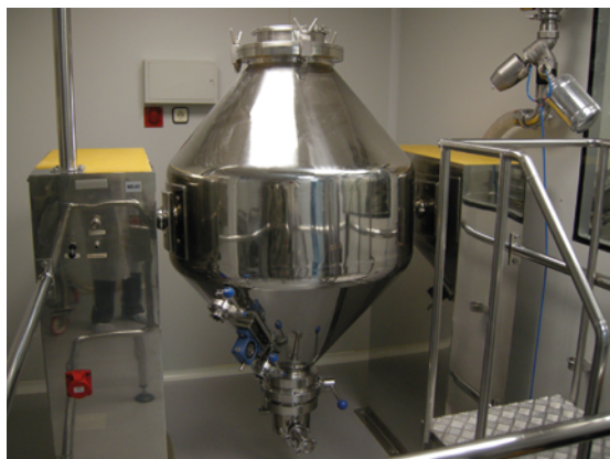
Miscelatore biconico con sistema di carico e scarico automatico
